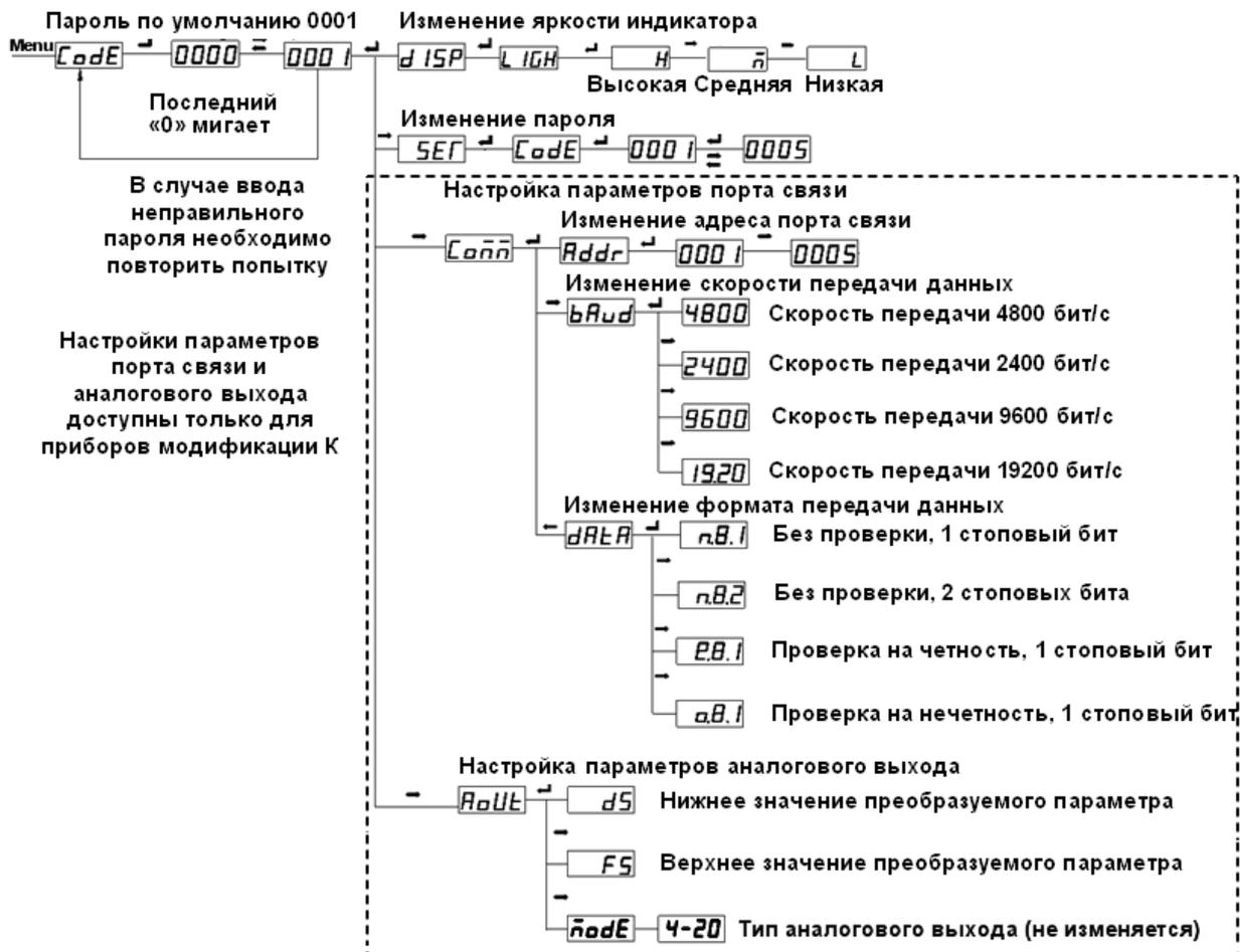
Рисунок 4.4 – Структура меню частотомеров PD194F модификаций X и K.
